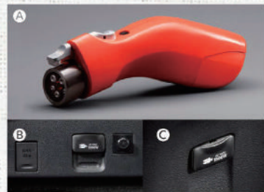
①ヴィークルパワーコネクタ ②アクセサリコンセント(ラゲージスペース左側) ③アクセサリコンセント(フロントコンソール後部)
