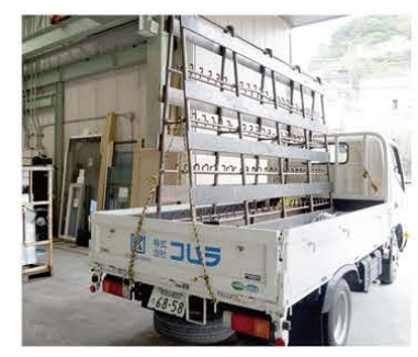
メーカーから届く大きなガラス板を、発注内容に合わせて様々なサイズに切断。トヨタのトラック「ダイナ」に搭載し、お客様のもとへ運びます。荷台でガラスやサッシを固定する機材のことを、この業界では「馬」と呼ぶのだとか。
